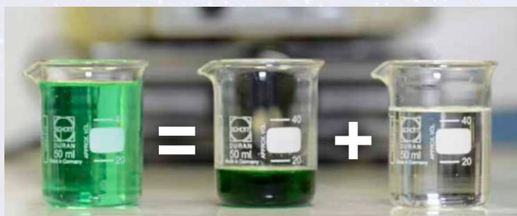
L'évaporation permet une concentration extrême des effluents et la production de condensats, recyclables ou rejeteables au milieu naturel.
